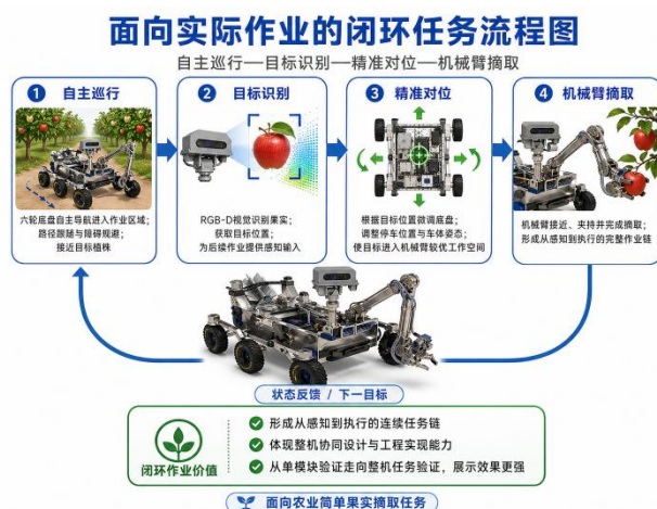
图16 面向实际作业的闭环任务流程图
